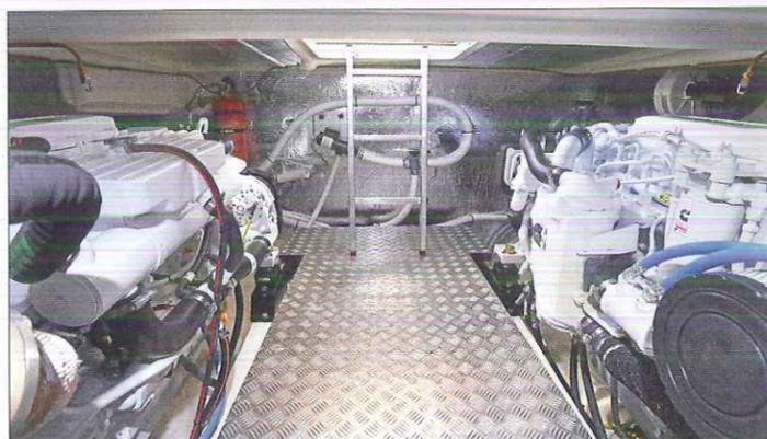
Compte tenu de la paire de 380 ch Cummins montée en V-drive, l'accessibilité de la soute technique est contrainte par une faible hauteur sous barrots.
